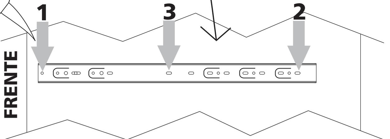
**1- Colocar los tornillos en las marcas 1 y 2. Luego colocar un tornillo como refuerzo al centro de la guía (3)**
