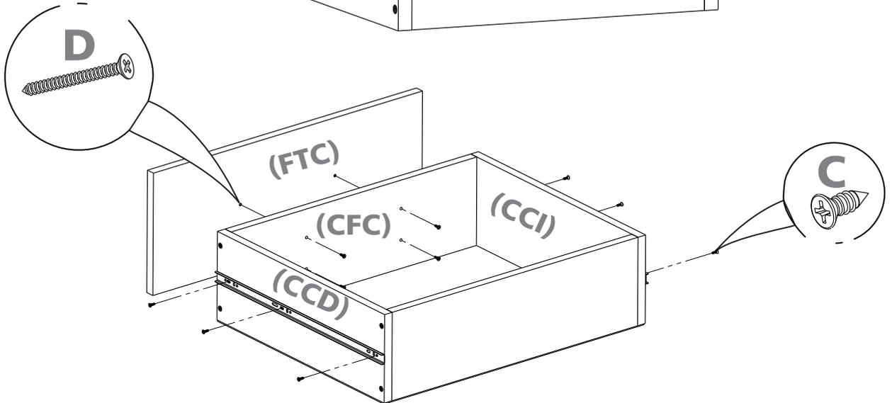
**1- Alinear la guía en los costados de cajón (CCI y CCD) y colocar dos tornillos donde coincidan con las marcas, dependiendo del modelo de la guía**
