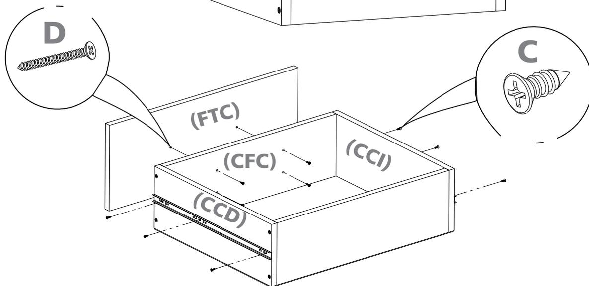
**1- Alinear la guía en los costados de cajón (CCI y CCD) y colocar dos tornillos donde coincidan con las marcas, dependiendo del modelo de la guía**
