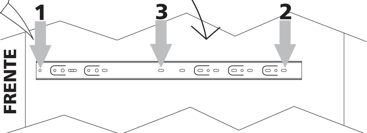
**1- Colocar los tornillos en las marcas 1 y 2. Luego colocar un tornillo como refuerzo al centro de la guia (3)**
