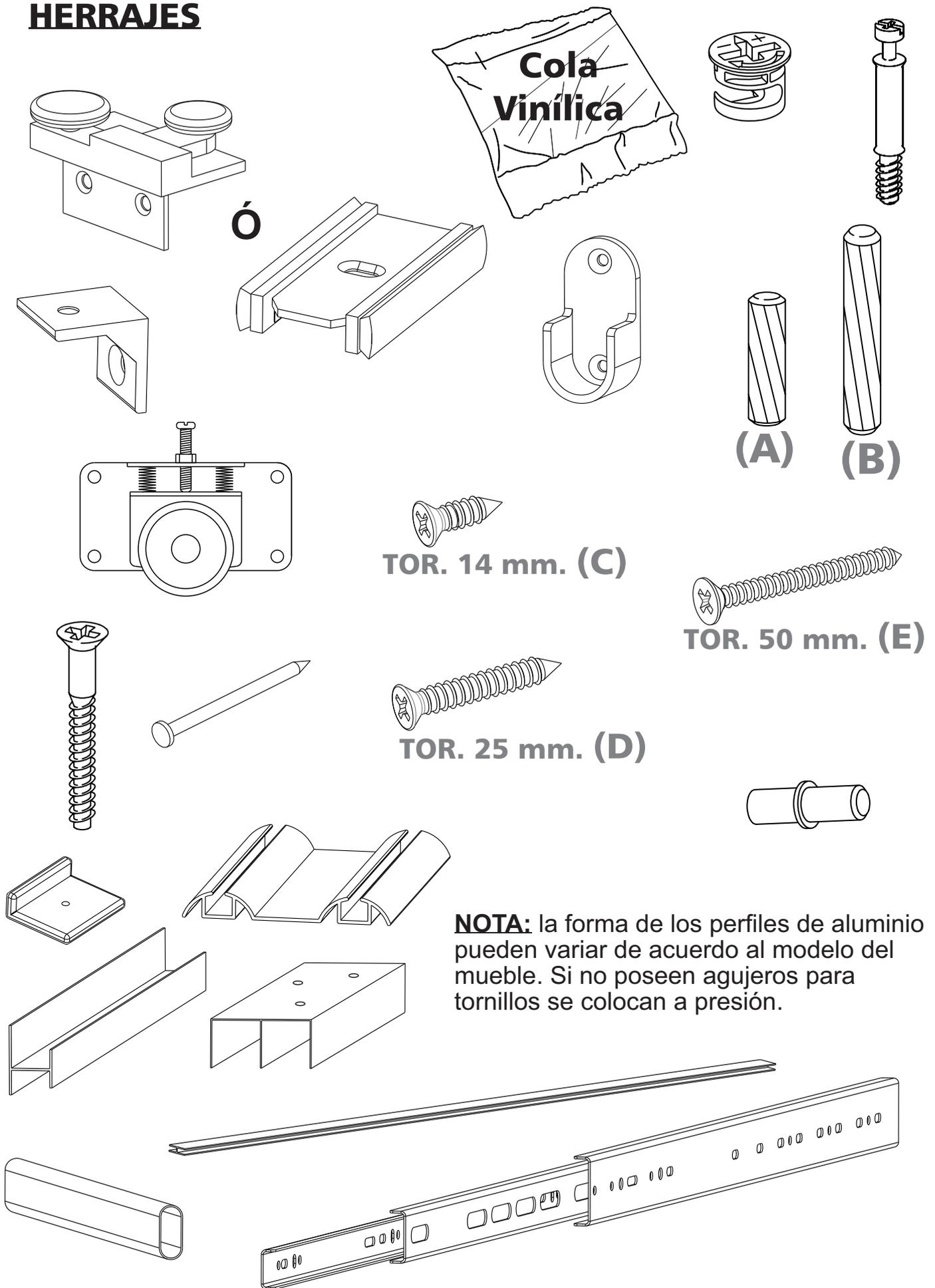
**NOTA:** la forma de los perfiles de aluminio pueden variar de acuerdo al modelo del mueble. Si no poseen agujeros para tornillos se colocan a presión.
