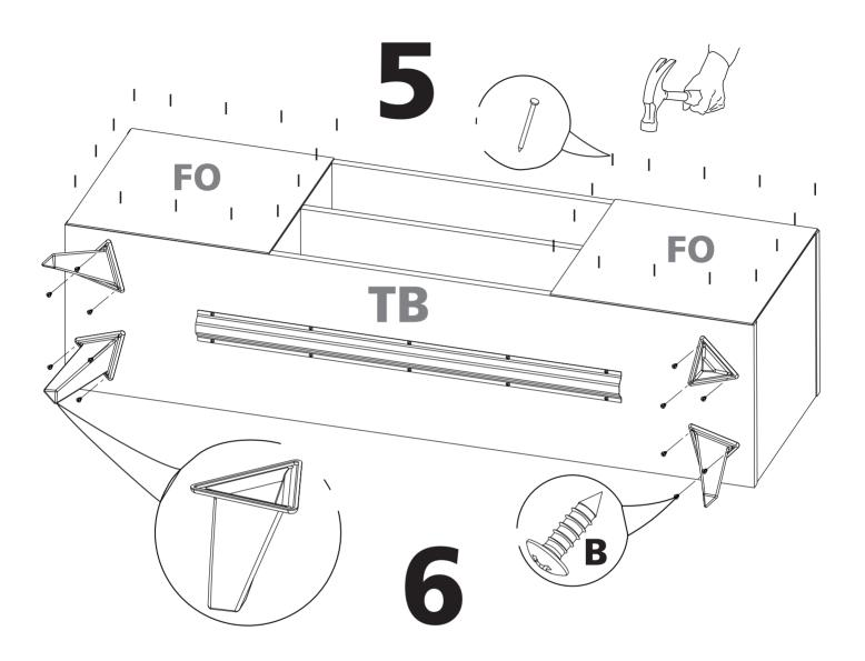
NOTA: colocar las patas en la base (B), utilizando la plantilla adjunta al instructivo
