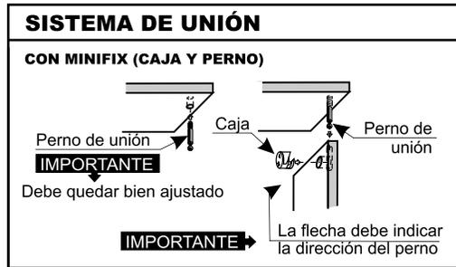
Colocar los 3 FRENTE (0) en posición horizontal con las perforaciones hacia arriba y en las dos perforaciones centrales, enroscar los pernos del minifix.
